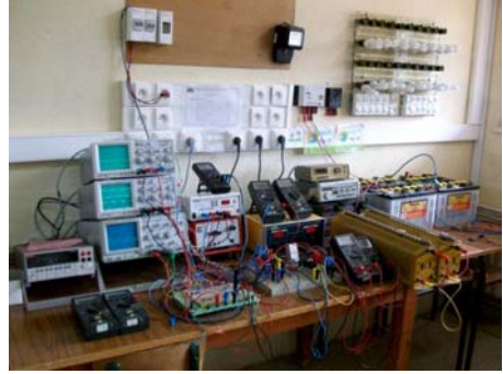
Fig. 4: Banc de mesure mis en place: Caractérisation modules et systèmes PV
